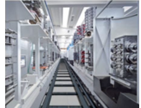
Centre de travail horizontal: production de boîtes de transmission et réducteurs
